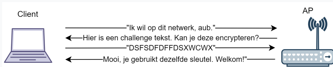
Figuur 4.7: De shared-key authentication aan de start van de verbinding.
